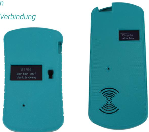
Die mit einem NFC Etikett markierte Spritze auf das Antennensymbol des Erkennungsgerätes **1 sec. halten**, bis das Display einen Wert anzeigt.
